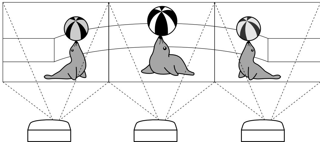
Um eine breite Videowand mit drei Projektoren in einer Reihe von links nach rechts (Siehe oben) einzurichten, wählen Sie „3 X 1“ in „Division“, wählen Sie eine Position für jeden Projektor und geben Sie dann das Bild ein, dessen Breite auf 1/3 gekürzt wurde ist (Siehe oben).
