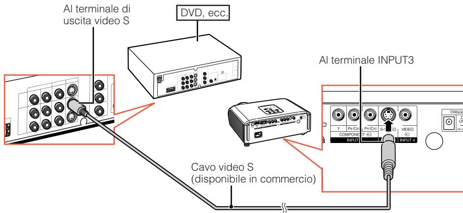
**Quando si esegue un collegamento a un'apparecchiatura dotata di terminale di uscita video (INPUT4)**
