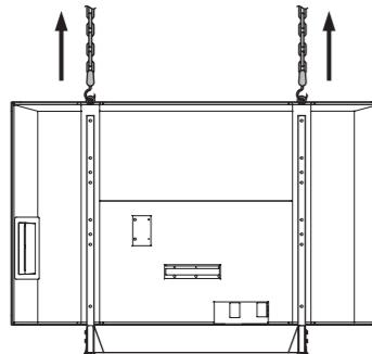
**3** Enlevez les boulons de montage du support à l'arrière et détachez le Moniteur LCD du support.
