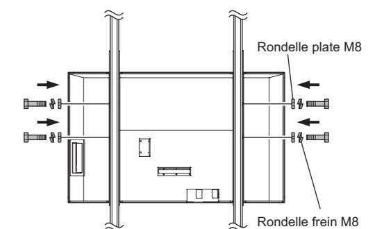
**7** Vérifiez que le Moniteur LCD est solidement fixé, puis enlevez les crochets du dispositif de levage.
