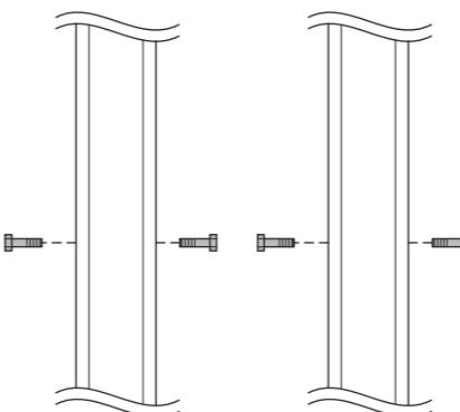
**6** Fixez le Moniteur LCD (supports de fixation) sur le cadre d'acier en H.
