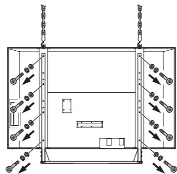
**4** Fixez les supports de fixation à l'arrière du Moniteur LCD.
