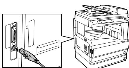
**2** Inserire l'altra estremità del cavo nel connettore USB del computer.
