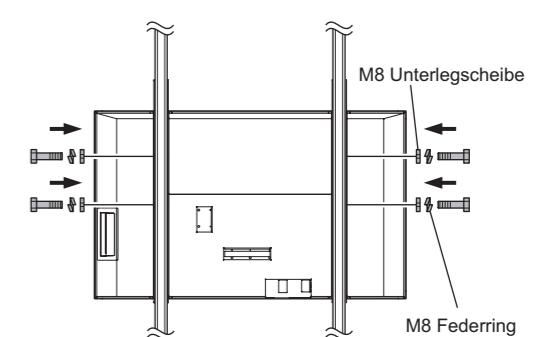
**7** Vergewissern Sie sich, dass der LCD-Farbmonitor sicher montiert ist, und entfernen Sie anschließend die Haken der Hebevorrichtung.
