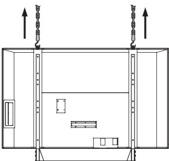
**3** Entfernen Sie auf der Rückseite die Bolzen zur Montage am Ständer und lösen Sie den LCD-Farbmonitor vom Ständer.
