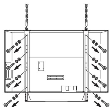
**4** Befestigen Sie die Wandhalterungen auf der Rückseite des LCD-Farbmonitors.
