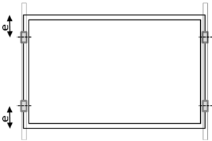
Bild A2: Klemmenposition an kurzer Rahmenseite
