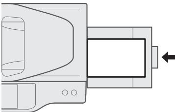
Le plateau d'alimentation auxiliaire est utilisé pour copier sur du papier qui n'est chargé dans aucun des magasins papier de la machine.
