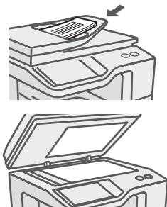
Si la dimension X (largeur) du document est inférieure à 89 mm (3-1/2") ou si la dimension Y (hauteur) est inférieure à 100 mm (4"), placez le document sur la vitre d'exposition.
