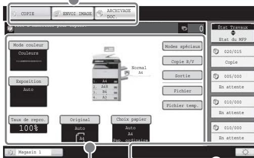
Si le mode de la machine est modifié, l'écran initial du mode choisi s'affiche. Les fonctions peuvent être sélectionnées et les réglages vérifiés sur l'écran initial.
