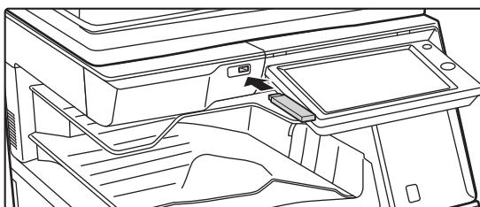
**Schließen Sie den USB-Speicher am Gerät an.**
