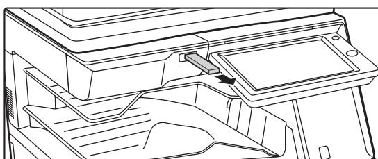
**Prüfen Sie die Nachricht [Datenversand komplett.] und trennen Sie den USB-Speicher vom Gerät.**
