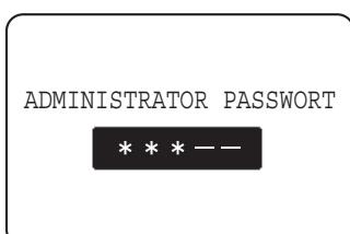
Jedes Mal wenn eine Ziffer eingegeben wird, werden die Bindestriche (-) im Display zu Sternchen (\*). Die Standardeinstellung ab Werk für den Gerätebetreuer-Code ist 00000.
