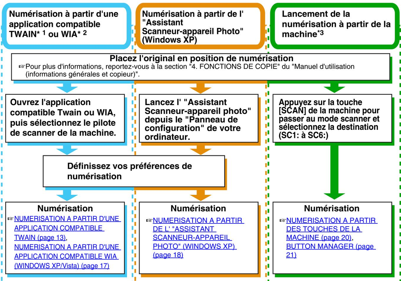
\*1 TWAIN est une norme d'interface internationale pour scanners et autres dispositifs d'acquisition d'images. En installant un pilote TWAIN sur votre ordinateur, vous pouvez numériser et travailler des images avec de nombreuses applications compatibles TWAIN.
