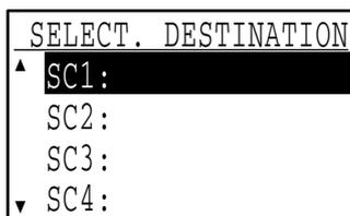
Le témoin lumineux de la touche [SCAN] s'allume pour indiquer que la machine est en mode scanner et l'écran de sélection de destination s'affiche. Dans Button Manager vous pouvez entrer un nom pour chaque destination "SC1:" à "SC6:". Il apparaîtra au format "SC1:XXXXX".
