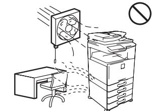
\* Das Gerät sollte so aufgebaut werden, dass Menschen nicht direkt ihrer Abluft ausgesetzt werden. Bei Aufstellen in der Nähe eines Fensters muss gewährleistet sein, dass das Gerät nicht direkt dem Sonnenlicht ausgesetzt ist.
