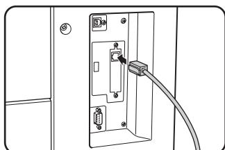
Pour connecter la machine à un réseau, branchez le câble LAN au connecteur réseau de la machine. (Sur les modèles MX-M550U/M620U/M700U, le kit d'extension réseau est requis.)
