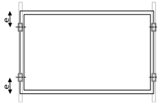
Schéma A2: Position de fixation par clip sur le côté court des cadres
