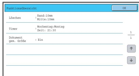
Die Einstellungen für die Spezialmodi können im Bildschirm Funktionsprüfung nicht geändert werden. Zum Ändern einer Einstellung berühren Sie die Taste [OK], um den Funktionsübersichtsbildschirm zu schließen, und anschließend die Taste [Spezialmodi], und wählen Sie jene Einstellung aus, die Sie ändern möchten.
