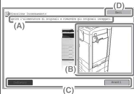
**(A) Istruzioni per la rimozione di un inceppamento che si verifica qui.**
