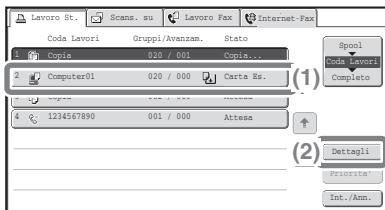
Premere il tasto [STATO LAVORI] sul pannello operatore per visualizzare la schermata dello stato lavori.
