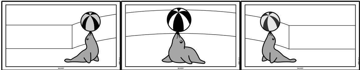
Um einen Mehrfachbildschirm in Breitbild mit drei Monitoren in einer Reihe von links nach rechts (wie oben gezeigt) zu erstellen, wählen Sie „3 X 1“ unter „Status“, wählen Sie eine Position für jeden Monitor, und geben Sie dann das Bild mit einer auf 1/3 komprimierten Breite (wie unten gezeigt) ein.
