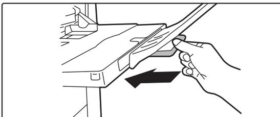
Reposez le guide d'extension du plateau d'alimentation auxiliaire.
