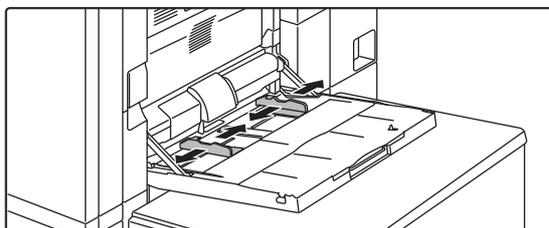
Ajustez les guides du plateau d'alimentation auxiliaire au format du papier à charger.
