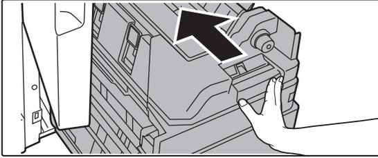
**Poussez le capot avant inférieur pour le remettre en place.**
