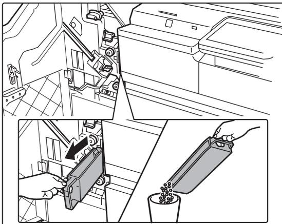
Extrayez la boîte de stockage des déchets de perforation et mettez au rebut les déchets de perforation.
