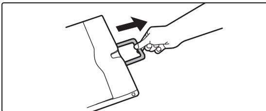
Extrayez le guide d'extension du plateau d'alimentation auxiliaire.
