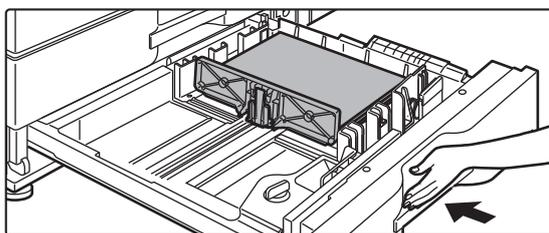
**Poussez avec soin le magasin dans l'appareil et réglez le type de papier sur Intercalaire.**
