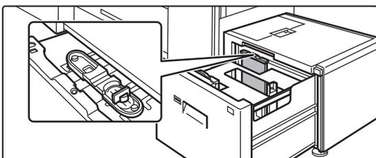
Répétez les étapes 1 à 4 pour régler le guide-papier arrière en fonction du format de papier à utiliser.
