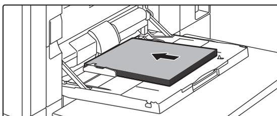
Insérez le papier entre les guides du plateau d'alimentation auxiliaire jusqu'à ce que le papier s'arrête.
