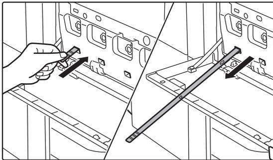
**Insérez complètement l'outil de nettoyage dans l'orifice, puis retirez-le.**
