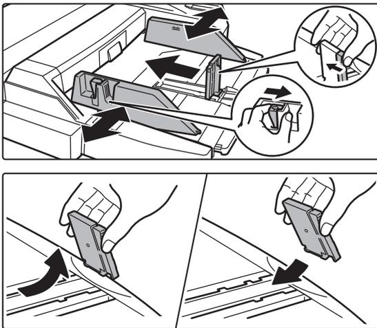
**Ajustez les guides du plateau d'alimentation auxiliaire au format du papier à charger.**
