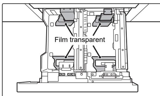
**Répétez les étapes 1 à 2 pour régler le guide-papier arrière en fonction du format de papier à utiliser.**
