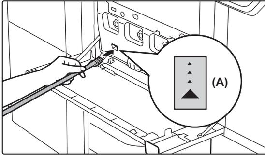
**Orientez le tampon vers le bas et insérez lentement l'outil dans l'orifice à nettoyer dans l'unité laser.**
