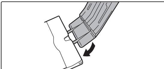
Fixez le magasin d'alimentation papier long au guide d'extension du plateau d'alimentation auxiliaire.
