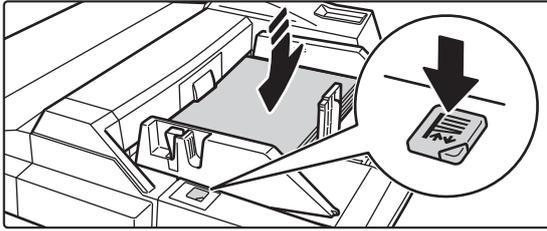
**Pour remplacer le papier du plateau d'alimentation auxiliaire, appuyez sur le bouton de fonctionnement et retirez le papier.**
