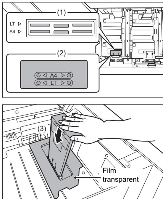
**Fixez le guide de format de papier et le film transparent de façon appropriée en fonction du format du papier à utiliser.**
