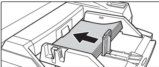
**Insérez le papier le long des guides du plateau d'alimentation auxiliaire jusqu'en butée et ajustez le guide droit.**
