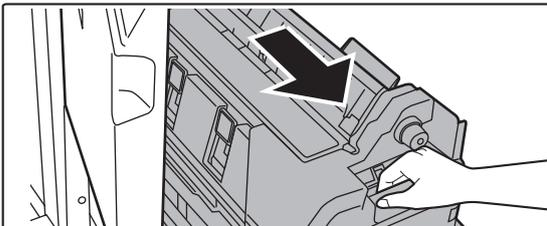
**Tirez doucement sur le capot avant inférieur jusqu'à ce qu'il s'arrête.**
