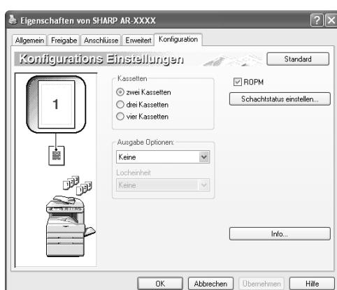
**5** Klicken Sie auf den "Schachtstatus einstellen" -Knopf und wählen Sie das Format des Papiers aus, das sich in den einzelne Kassetten befindet. Wählen Sie eine Kassette aus dem "Papierzufuhr" Menü aus und wählen Sie das Format des in dieser Kassette befindlichen Papiers aus dem "Einstellung Papierformat" Menü aus. Führen Sie das bei jeder Kassette durch.
