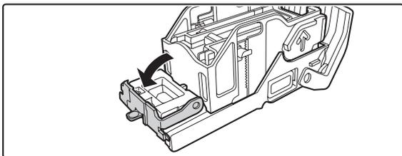
**Abbassare la leva all'estremità anteriore del contenitore dei punti.**
