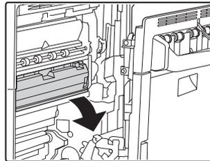
Se la carta inceppata si trova all'interno dell'area di funzione, premere sulla parte verde per inclinare verso il basso l'unità fusore verso l'operatore.
