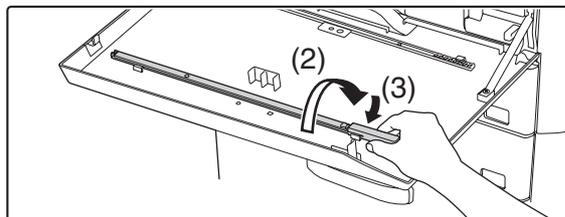
(2) Posizionare il lato destro del pulitore del caricatore nel lato interno, aperto sulla parte superiore della griffa.
