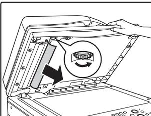
Aprire l'alimentatore automatico di documenti. Ruotare il rullo di trasferimento nella direzione indicata dalla freccia e rimuovere l'originale.
