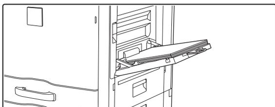
Se viene caricata carta di grande formato, estrarre l'estensione del vassoio bypass. Estrarre completamente l'estensione del vassoio bypass. Se non si estrae completamente tale vassoio, il formato della carta caricata non verrà visualizzato correttamente.
