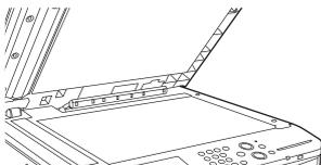
Se la dimensione X (larghezza) del documento è inferiore a 140 mm (5-1/2") o la dimensione Y (altezza) è inferiore a 131 mm (5-1/8"), posizionare l'originale sulla lastra di esposizione. Per un originale sottile, utilizzare "Scans. Lenta".
