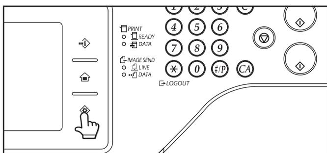
Assicurarsi che la macchina sia in stato di standby, quindi toccare il tasto [IMPOSTAZIONI DI SISTEMA] (◊) sul pannello a sfioramento. Se viene toccato il tasto [IMPOSTAZIONI DI SISTEMA] (◊), nel pannello a sfioramento viene visualizzata la schermata di menu seguente.
