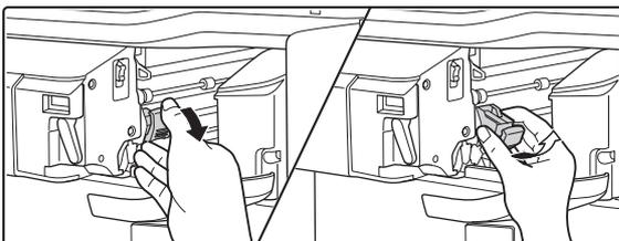
**Abbassare la leva di sblocco del contenitore dei punti metallici, quindi estrarre il contenitore.**
