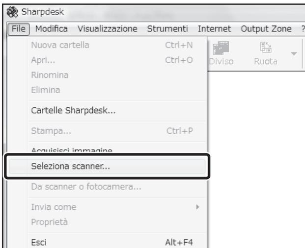
Avviare l'applicazione compatibile TWAIN nel computer e scegliere **[Seleziona scanner]** nel menu **[File]**.
