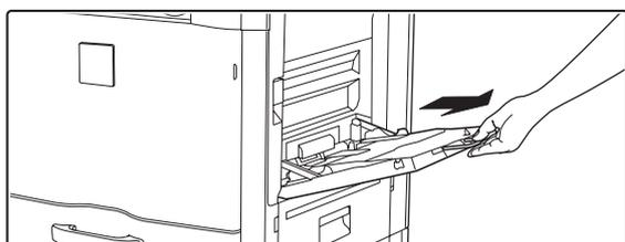
Se viene caricata carta di grande formato, estrarre l'estensione del vassoio bypass. Estrarre completamente l'estensione del vassoio bypass.
