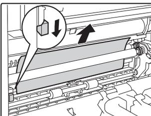
Abbassare la levetta in direzione della freccia per togliere la carta inceppata.
