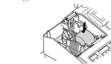
Avant de positionner un nouveau rouleau de papier dans le support du rouleau, couper la partie collée (bande adhésive) du papier et vérifier que l'extrémité coupée du papier soit bien droite.
