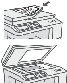
Se la dimensione X (larghezza) del documento è inferiore a 89 mm (3-1/2") o la dimensione Y (altezza) è inferiore a 100 mm (4"), posizionare l'originale sulla lastra di esposizione. Se si utilizza l'alimentatore automatico, utilizzare "Modo di scan.lento" per un originale sottile.
