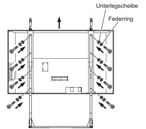
**7** Vergewissern Sie sich, dass der LCD-Farbmonitor sicher montiert ist, und entfernen Sie anschließend die Haken der Hebevorrichtung.
