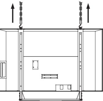
**3** Entfernen Sie auf der Rückseite die Bolzen zur Montage am Ständer und lösen Sie den LCD-Farbmonitor vom Ständer.
