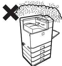
Bei Staubeintritt in das Gerät können verschmutzte Ausdrucke und Gerätestörungen verursacht werden.
