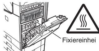
Beim Laden von Papier, Entfernen von Papierstaus, Wartungsarbeiten, Schließen der vorderen und seitlichen Abdeckungen und Einsetzen bzw. Entfernen der Fächer besteht Gefahr, sich die Finger zu klemmen.
