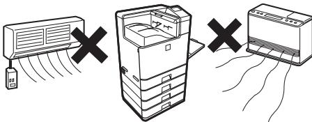
Das Papier kann feucht werden und im Geräteinneren kann sich Kondensation abscheiden, was zu Einzugsstörungen oder schmutziger Ausgabe führen kann.
