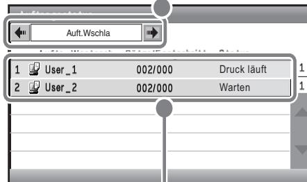
Die Jobs werden in Listenform angezeigt. Die Jobs werden in der Reihenfolge ihrer Ausführung angezeigt. Sie können einen ausgewählten Job mit einer Priorität versehen und ihn vor anderen Jobs ausführen. Außerdem kann ein in der Warteschlange befindlicher Job abgebrochen werden.
