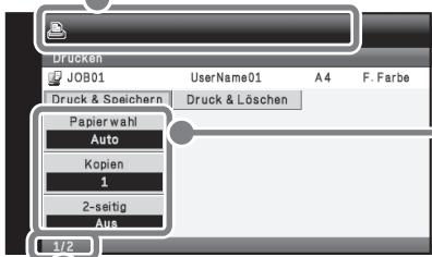
Hier werden die Einstellungen angezeigt. Wenn Sie die Taste  $\nabla$  drücken, während sich der Auswahlrahmen auf der unteren Einstellung befindet, wird der nächste Bildschirm angezeigt.
