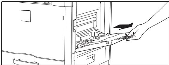
Achten Sie beim Einlegen von großformatigem Papier, dass Sie die Erweiterung des manuellen Einzugs herausziehen. Ziehen Sie die Verlängerung des manuellen Einzugs komplett heraus.
