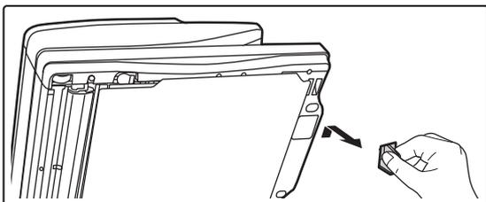
Öffnen Sie den automatischen Originaleinzug und entfernen Sie den Glasreiniger.
