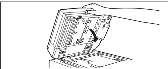
**Schließen Sie den automatischen Originaleinzug, um die Dokumentenabdeckung zu befestigen.**
