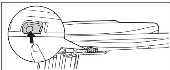
Öffnen Sie die Abdeckung des Scanbereichs im automatischen Originaleinzug.
