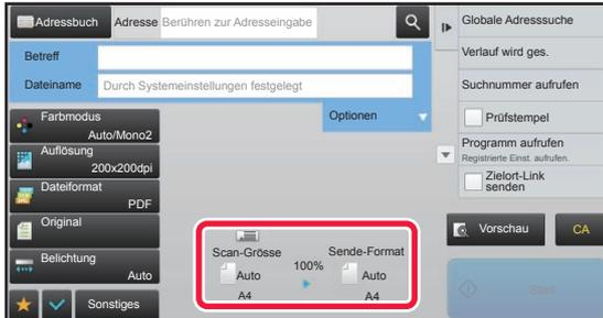
Im oben dargestellten Bildschirm ist die Scangröße (das Originalformat) A4 (8-1/2" x 11") und das Sendeformat Auto. Wenn die Scangröße zum Beispiel A4 (8-1/2" x 11") und das Sendeformat B5 (5-1/2" x 8-1/2") ist, wird das Bild vor der Übertragung verkleinert.
