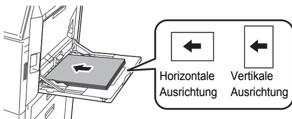
**Legen Sie die Transparentfolie mit der Druckseite nach unten in den manuellen Einzug ein, und legen Sie Transparentfolienblätter ein.**
