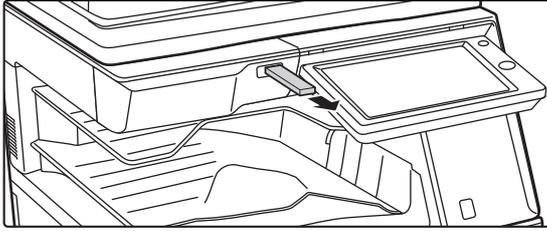
**Warten Sie die Meldung [Datenversand komplett.] ab, und trennen Sie das USB-Speichergerät vom Gerät.**
