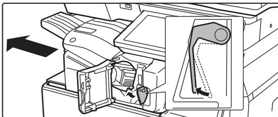
Drücken Sie den Hebel nach unten links, und schieben Sie den Finisher bis zum Anschlag nach links.
