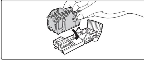
**Setzen Sie eine neue Heftklammernpatrone in den Heftklammernkasten ein (siehe Abbildung).**
