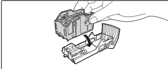
**Setzen Sie eine neue Heftklammernpatrone in den Heftklammernkasten ein (siehe Abbildung).**
