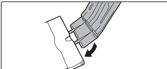
Befestigen Sie das lange Papiereinzugsfach auf der Erweiterung des manuellen Einzugs.
