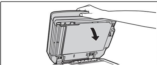
**Stellen Sie sicher, dass die Dokumentenabdeckung fest am automatischen Originaleinzug befestigt ist und schließen Sie diesen.**
