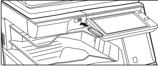
Schließen Sie das USB-Speichergerät am Gerät an.
