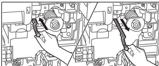
**Reinigen Sie die Hauptladeeinheit.**
