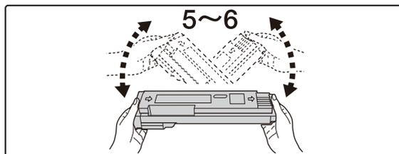
**Entnehmen Sie eine neue Tonerpatrone aus der Verpackung, und schütteln Sie diese fünf oder sechs Mal.**
