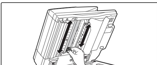
Reinigen Sie den Scanbereich im automatischen Originaleinzug.
