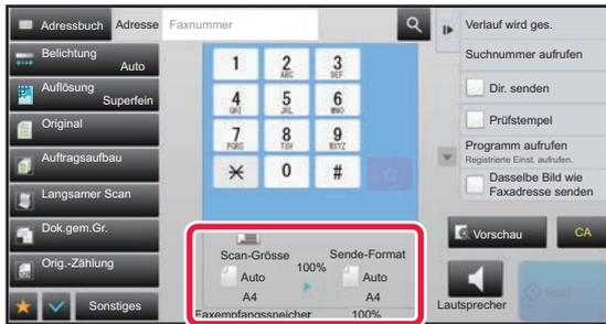
Im oben dargestellten Bildschirm ist die Scangröße (das Originalformat) A4 (8-1/2" x 11") und das Sendeformat Auto. Wenn die Scangröße zum Beispiel A4 (8-1/2" x 11") und das Sendeformat B5 (5-1/2" x 8-1/2") ist, wird das Bild vor der Übertragung verkleinert.
