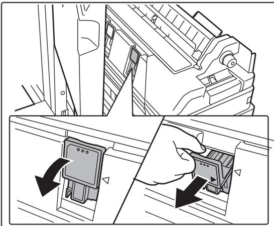
Entfernen Sie den Heftklammernkasten.
