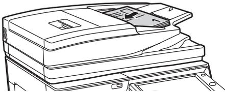
**Legen Sie das Original in das Originaleinzugsfach des automatischen Originaleinzugs ein.**
