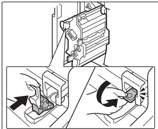
**Montieren Sie den Heftklammernkasten.**
