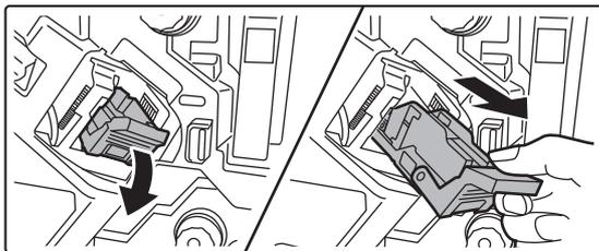
Entfernen Sie den Heftklammernkasten.
