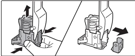
**Entnehmen Sie die leere Heftklammernpatrone aus dem Heftklammernkasten.**
