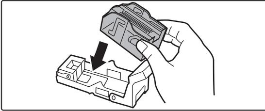
**Setzen Sie eine neue Heftklammernpatrone in den Heftklammernkasten ein.**
