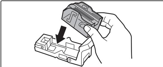
**Setzen Sie eine neue Heftklammernpatrone in den Heftklammernkasten ein.**
