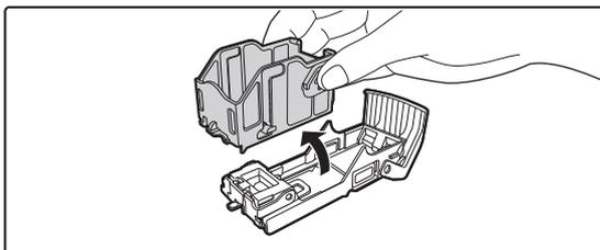
Entnehmen Sie die leere Heftklammernpatrone aus dem Heftklammernkasten.
