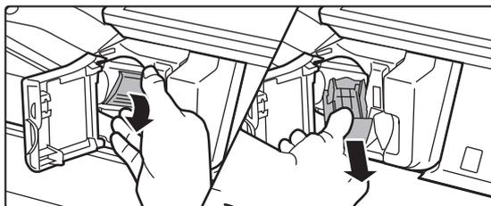
Drücken Sie den Auslösehebel des Heftklammernkastens nach unten und entfernen Sie den Heftklammernkasten.
