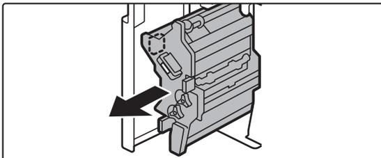
**Ziehen Sie am Hebel und entnehmen Sie die Hefereinheit.**
