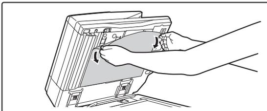
Entfernen Sie die Dokumentenabdeckung aus dem automatischen Originaleinzug.
