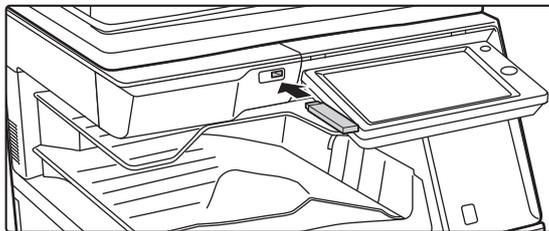
**Schließen Sie das USB-Speichergerät am Gerät an.**
