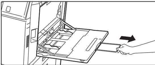
Ziehen Sie bei der Verwendung von Papier, das größer als 8-1/2" x 11"R oder A4R ist, die verlängerte Führung heraus. Ziehen Sie die Erweiterung vollständig heraus.
