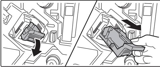
**Entfernen Sie den Heftklammernkasten.**
