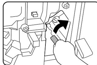
Abbassare la guida della carta in direzione della freccia.
