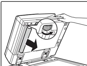
Aprire l'alimentatore documenti automatico. Ruotare l'unità rotante di trasferimento nella direzione della freccia e rimuovere l'originale.
