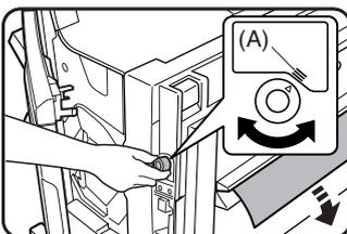
Ruotare la manopola verde fino a che la freccia non si trova nell'intervallo (A) riportato sull'etichetta. A questo punto, rimuovere la carta inceppata. Prestare attenzione a non strappare la carta inceppata durante la rimozione.
