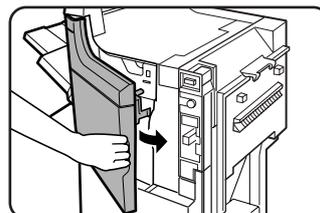
Chiudere lo sportello anteriore del finitore/finitore con pinzatura a sella.
