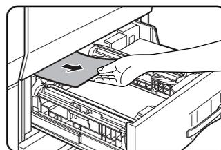
Quando si utilizza il vassoio 2, il vassoio bypass o il vassoio alta capacità, controllare l'unità di trasferimento carta all'interno del vassoio e rimuovere la carta eventualmente inceppata.
