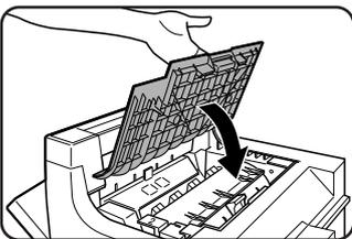
Chiudere lo sportello superiore del finitore/finitore con pinzatura a sella.
