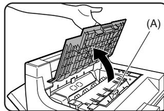
Aprire lo sportello superiore del finitore/finitore con pinzatura a sella. Quando l'inseritore è installato, sollevarne il relativo vassoio.
