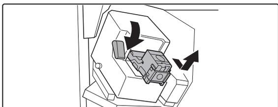
Abbassare la leva blu della pinzatrice ed estrarre la cartuccia dei punti metallici.
