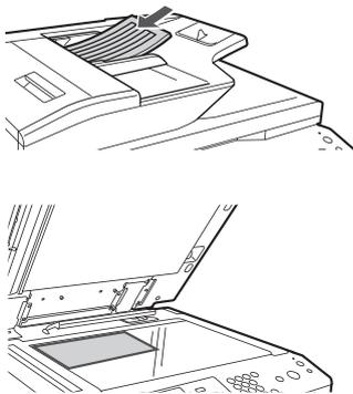
Se la dimensione X (larghezza) del documento è inferiore a 140 mm (5-1/2") o la dimensione Y (altezza) è inferiore a 131 mm (5-1/8"), posizionare l'originale sulla lastra di esposizione. Per un originale sottile, utilizzare "Scans. Lenta".
