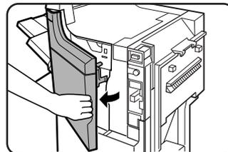
Aprire lo sportello anteriore del finitore/finitore con pinzatura a sella.
