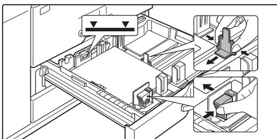
**Regolare le piastre delle guide A e B premendo le leve di bloccaggio e facendole scivolare verso il formato carta da caricare.**
