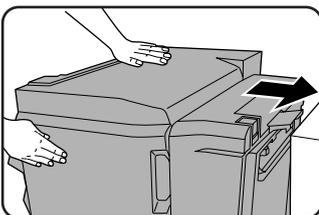
Spingere il finitore e fissarlo delicatamente alla macchina.
