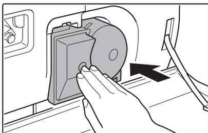
**Inserire la cartuccia spingendola finché non si blocca saldamente in posizione.**
