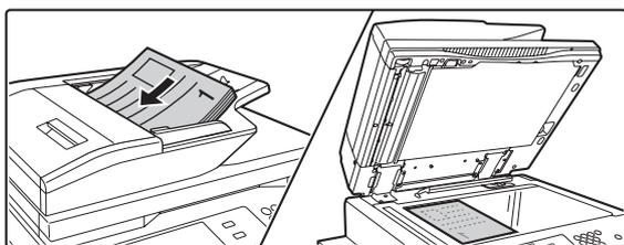
Posizionare l'originale nel vassoio dell'alimentatore di documenti automatico, oppure sulla lastra di esposizione.
