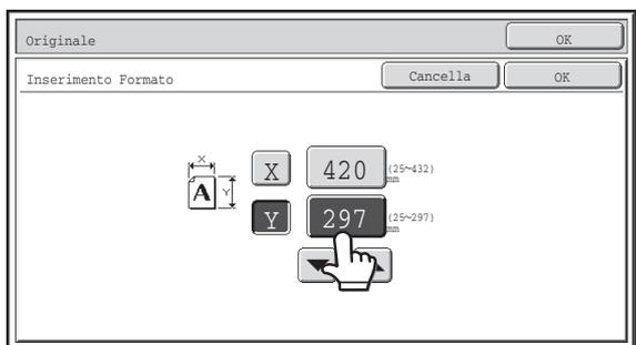
Premere il tasto del display con valori numerici per immettere direttamente un valore con i tasti numerici.
