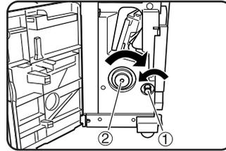
Ruotare la manopola di destra ① in senso antiorario. Quindi, spingere la manopola di sinistra ② e ruotarla in senso orario.
