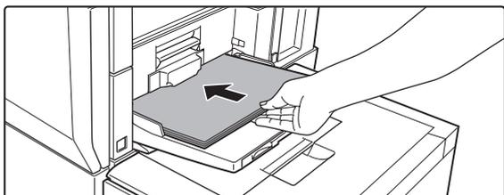
**Inserire completamente la carta lungo le guide del vassoio bypass in tale vassoio finché non si arresta.**
