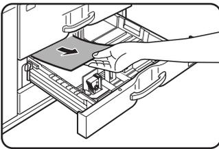
Se, conformemente all'immagine del passaggio precedente, l'inceppamento non è stato riscontato, estrarre il vassoio 3 della carta e rimuovere l'inceppamento da lì. Estrarre completamente il vassoio finché non si ferma. Controllare l'unità di trasferimento carta all'interno del vassoio. Prestare attenzione a non strappare la carta inceppata durante la rimozione.
