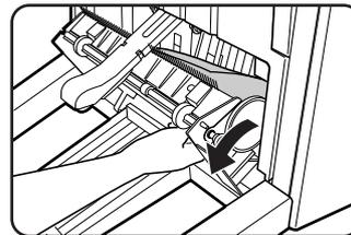
Aprire lo sportello di uscita dell'unità di pinzatura a sella, quindi rimuovere l'inceppamento. Prestare attenzione a non strappare la carta inceppata durante la rimozione.
