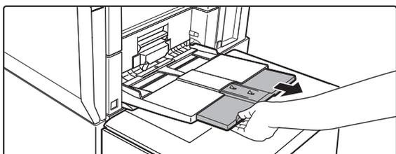
Se si carica della carta con formato superiore ad A4R o 8-1/2" x 11"R, assicurarsi di estrarre l'estensione del vassoio bypass. Estrarre completamente l'estensione del vassoio bypass. Se non si estrae completamente tale vassoio, il formato della carta caricata non verrà visualizzato correttamente.
