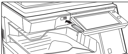
**Schließen Sie den USB-Speicher am Gerät an.**
