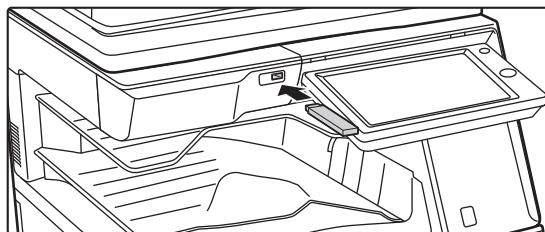
**Schließen Sie den USB-Speicher am Gerät an.**
