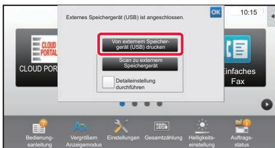
**Sobald der Bildschirm zum Auswählen einer Aktion angezeigt wird, berühren Sie [Von externem Speicher- gerät (USB) drucken].**
