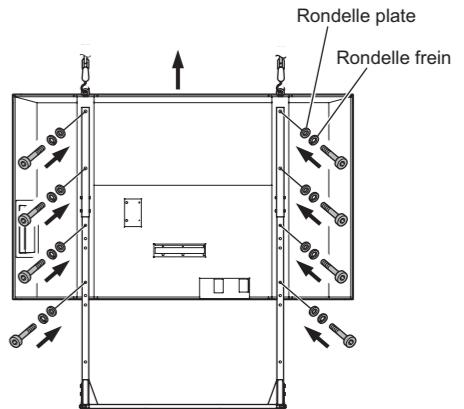
**7 Vérifiez que le Moniteur LCD est solidement fixé, puis enlevez les crochets du dispositif de levage.**
