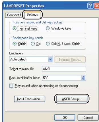
**7** Markieren Sie die Kästchen für die Optionen „Send line ends with line feeds“ (Senden des Zeilenendes mit Zeilenvorschüben), „Echo typed characters locally“ (Eingegebene Zeichen lokal ausgeben) und „Append line feeds to incoming line ends“ (Angehängte Zeilenvorschübe zu ankommenden Zeilenvorschüben) und klicken Sie „OK“.
